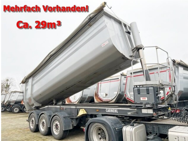
CARNEHL CHKS34/HS, Stahlmulde ca. 29m 3 , HARDOX, Liftachse, Schütte, mehrfach Vorh.!
